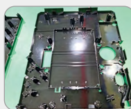
[전자레인지용 Inverter PCB base 및 Air Guide]
